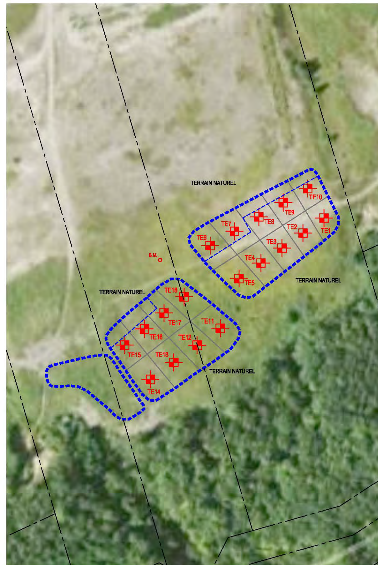
ÉCHANTILLONNAGE PAR TRANCÉES EXPLORATOIRES
